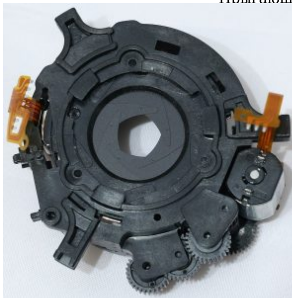
Электромагнитный исполнительный механизм прыгающей диафрагмы объектива Canon EF
