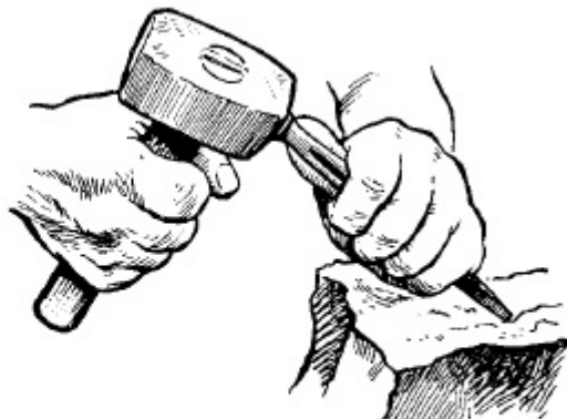
Рис. 6. Правильный (обычный) наклон троянки во время работы
