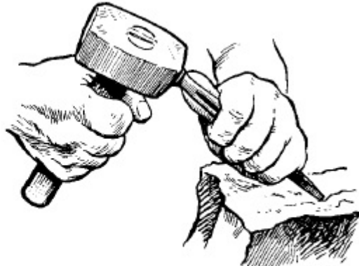
Рис. 6. Правильный (обычный) наклон троянки во время работы
